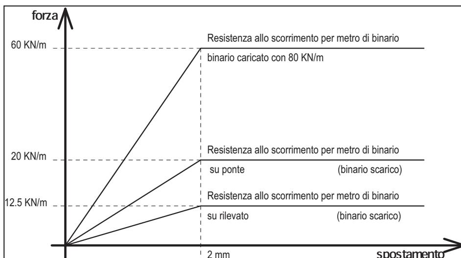
Fig. 6.3.8 - Legame forza-spostamento del ballast in direzione longitudinale.
