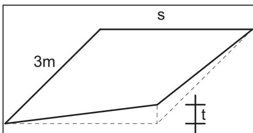
Fig. 6.3.18 *Sghembo ammissibile*
