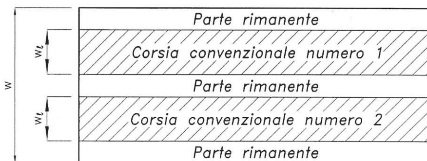
Figura 6.2.1 – Esempio di numerazione delle corsie
